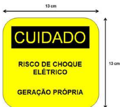
Figura 5.4: Placa de advertência a ser fixada no ramal de entrada.
