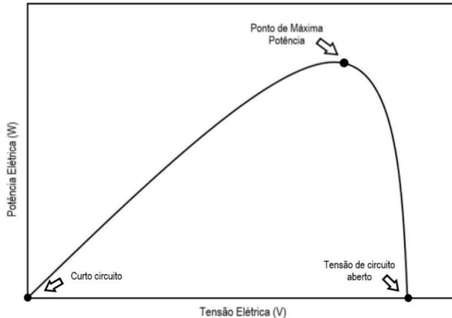
Figura 3: Curva característica P-V de um painel fotovoltaico.
