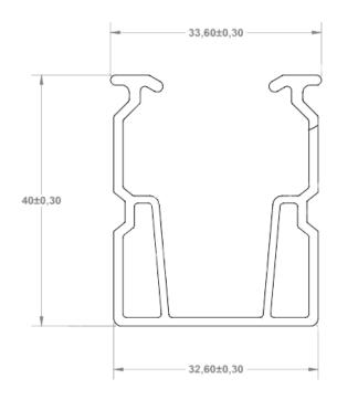
O Perfil U acompanha borracha de vedação e parafusos de fixação.
