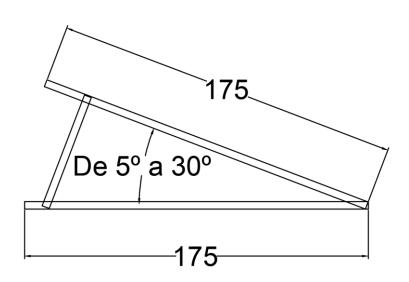
O triângulo de inclinação acompanha 3 parafusos, 6 arruelas, 3 porcas e dois grampos inferiores.
