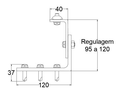
Ajusde de altura suporte de fixação telhado metálico.
