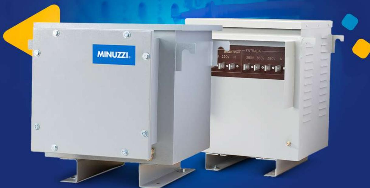
São fabricados com núcleos magnéticos de aço orientado e com baixa indução, para suportar o regime de trabalho e as variações de tensão do sistema de chaveamento dos inversores, utilizam condutores de alta pureza e materiais isolantes que suportam temperaturas elevadas, gerando um excelente desempenho em aplicações fotovoltaicas.
