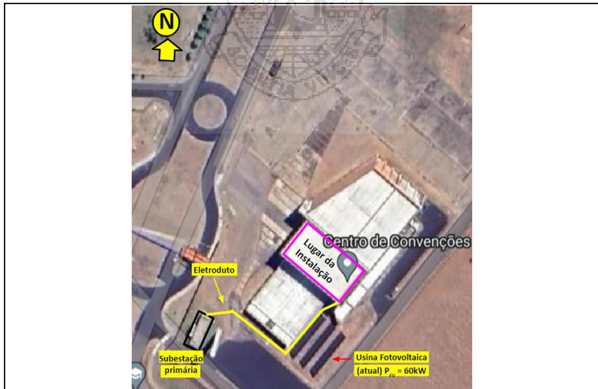
Fig1d: Segunda vista aérea e disposição do local de instalação e eletroduto do centro de convenções
