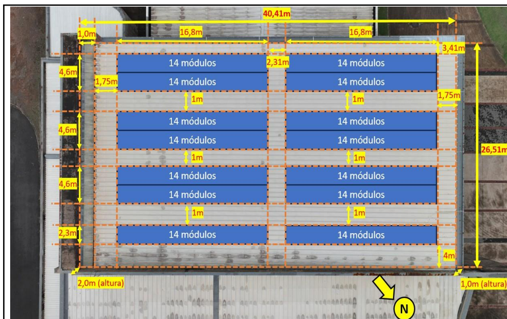
Fig 1g: Layout dos módulos fotovoltaicos
